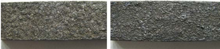
Рис. 3 Зовнішній вигляд зразків після зміцнення ЕІЛ а) по режиму №7; б) по режиму №4
