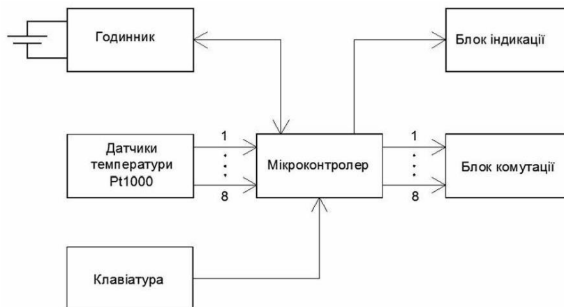
Рис 1. Структурна схема автоматизованої системи геліоколектора
