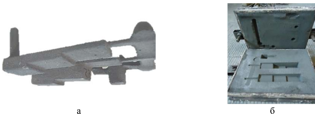
Рис. 2. Общий вид чугуных ступенчатых проб (а) и литейной формы перед сборкой (б) для их изготовления
