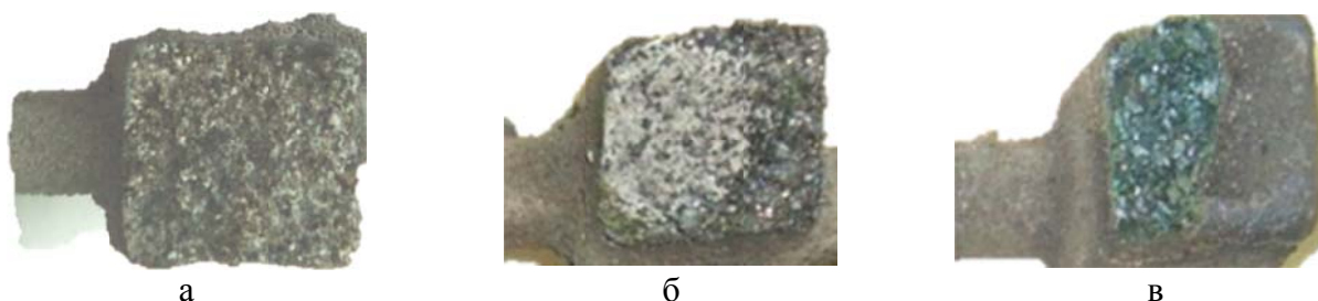
Рис. 3. Вид снизу на реакционные камеры с остатками непрореагировавших добавок: а – ФБ18; б – ФХ900; в – Мн95
