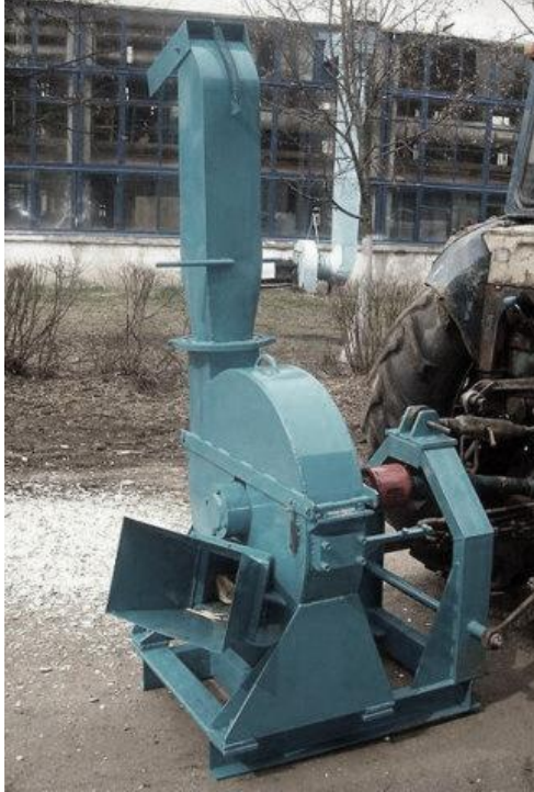
Рис. 1. Мобільна модифікація подрібнювача (привод від ВВП трактора)
