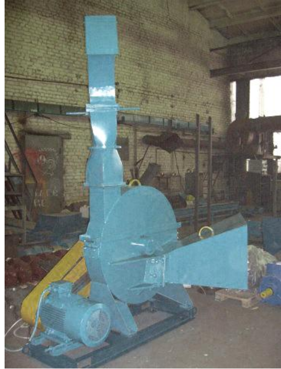
Рис. 2. Стационарна модифікація (привод від електричного двигуна)
