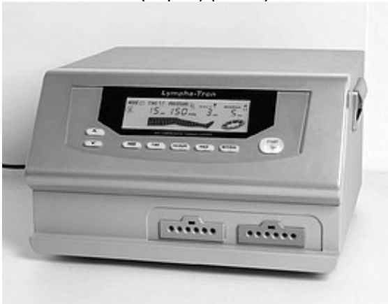
Рис. 3. Апарат переміжної пневматичної компресії Lymphatron DL 1200L
