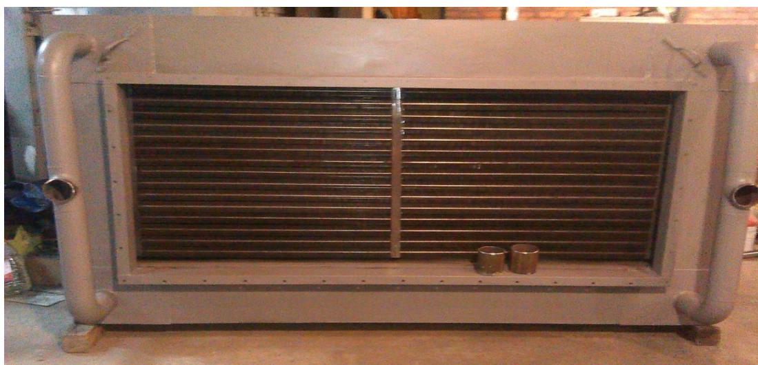
Рис. 3. Загальний вид економайзера для котла ПТВМ-30м
