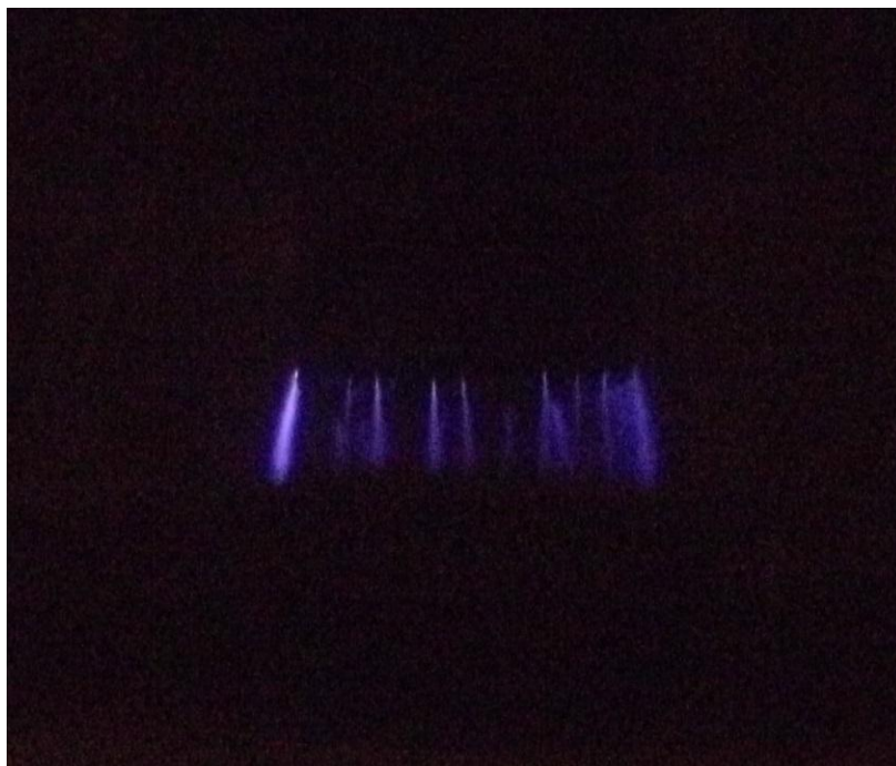
Рис.11. Свічення імпульсного коронного розряду наносекундної тривалості над поверхнею 10% водного розчину сульфату цинку при між електродній віддалі 7.5 мм та товщини шару рідини 4 мм [15].
