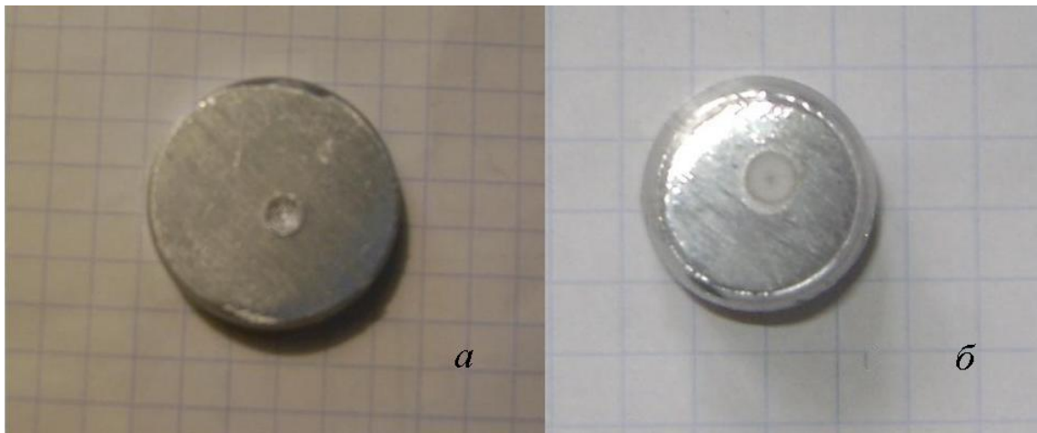
Рис.4. Кратери, які утворюються на поверхні плоских електродів: алюмінієвий (а) і дюралюмінієвий (б) електроди після експерименту, який тривав 20 – 30 хвилин [3].
