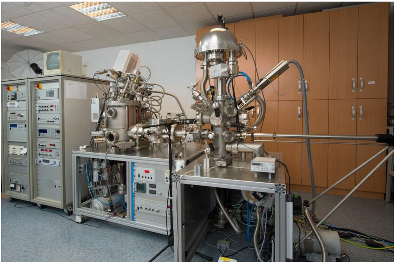
Рис. 2.6. Загальний вигляд установки (Specs GmbH, Берлін, Німеччина) для вимірювання рентгенофотоелектронних спектрів.
