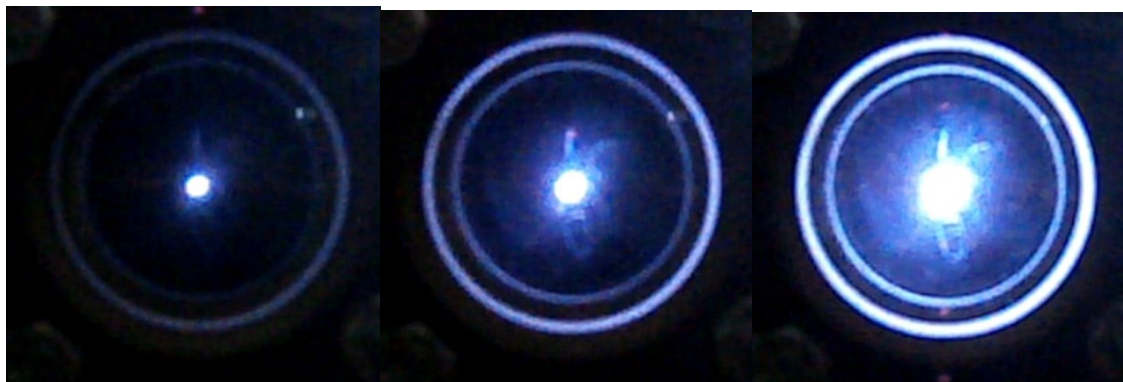
Рис.1.11 - Світлини перенапруженого високовольтного наносекундного розряду між мідними електродами при частотах слідування імпульсів (зліва на право) 40, 150 і 1000 Гц [29].
