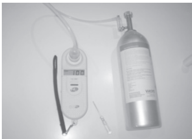
Мал. 5. Портативний електрохімічний аналізатор концентрації водню в повітрі. Апарат щойно відкалібрований
