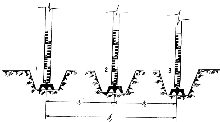
Рис. 21 Схема нівелювання за трьома башмаками
