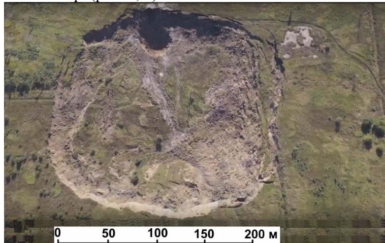
Рис.1. Форма та розміри провалу що стався 30 вересня 2017 року на руднику № 2 Стебницького ГХП «Полімінерал» над ділянкою руйнування ціликів між камерами № 108-109-110-111-112-113 пласта № 10 ПД-Сх (зйомка з ДРОНа)
