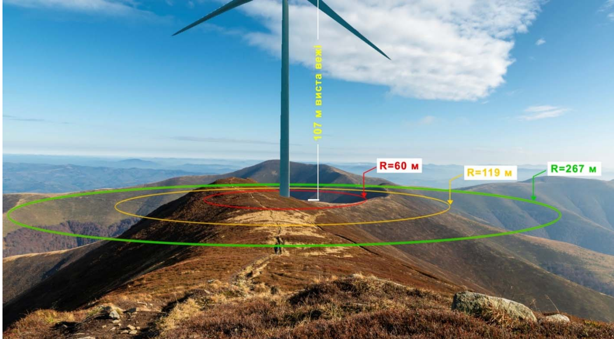
Рис. 1. Небезпечні зони падіння і розльоту уламків криги з елементів конструкції вітрової турбіни у періоді обмерзання: 60м – зона падіння уламків льоду при зупиненій ВЕУ і вітрі 5 м/с, 119 м - зона падіння уламків льоду при зупиненій ВЕУ і вітрі 10 м/с, 267 м - зона розльоту уламків льоду при роботі ВЕУ (розрахунки авторів звіту з ОВД [1]).
