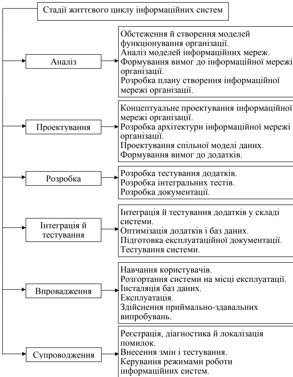
Рис. 1. Стадії життєвого циклу інформаційних систем
