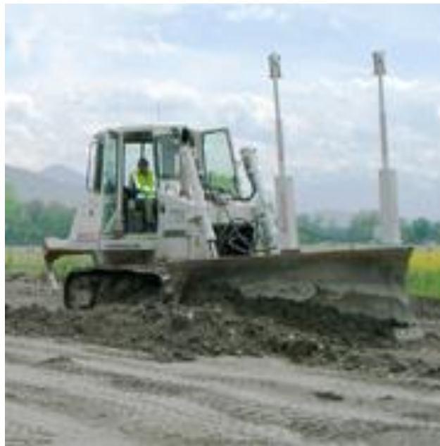
Рис. 26. Програмно-апаратний комплекс Leica PowerGrade для грейдерів і бульдозерів
