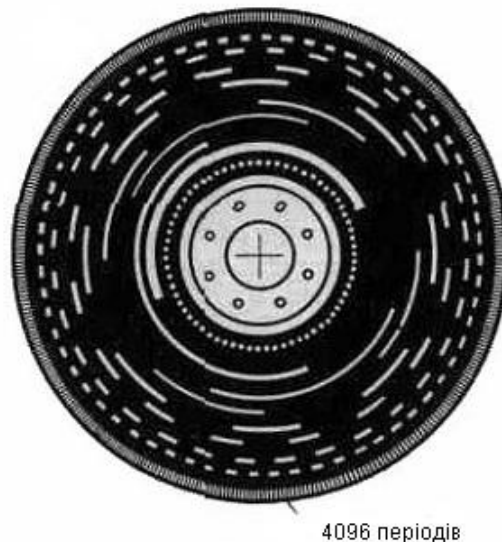
Рис. 13. Приклад кодованого круга в електронному теодоліті
