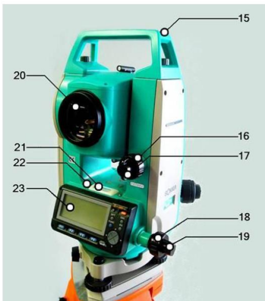
Рис. 40. Будова електронного тахеометра Sokkia SET610 (вид ззаді)
