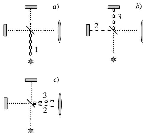
Рис.5. Движение пучка фотонов в интерферометре Майкельсона:
