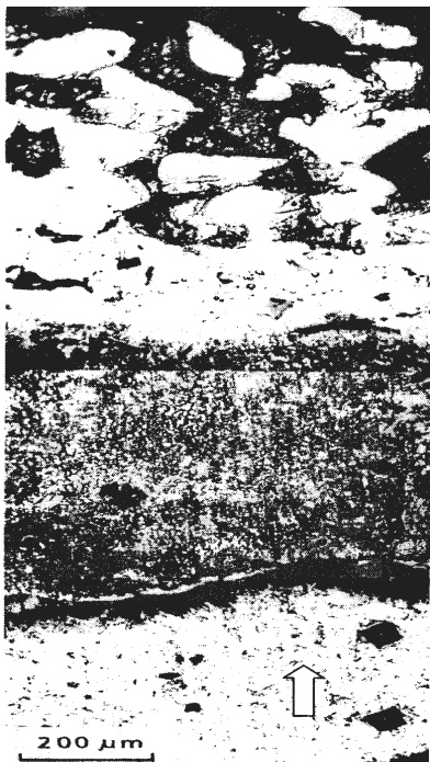
Рис. 5. Мікроструктура поперечного розрізу мікрошліфа сталі після комбінованого її зміцнення ЛПЗ і СВС
