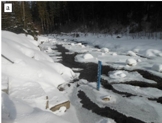
Рис. 5. Коливання рівня води у р. Прут на гідропості № 1 (“Прут”) ЧГС: а) зимовий межень (лютий 2019 р.); б) весняне водопілля (квітень 2018 р.). Фото: Гнатяк І.
