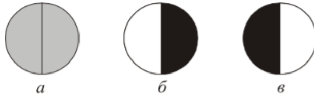
Рис. 9. Поля порівняння яскравості у цукрометрі СУ-4.
