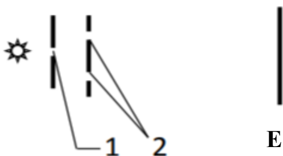
Рис. 1. Схема класичного інтерференційного досліді Юнга.
