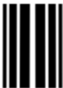
Рис. 4. Дифракційна картина на екрані від тонкої нитки.
