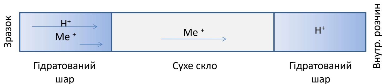
Рис. 3.8. Будова гідратованого шару скляного рН сенсора.
