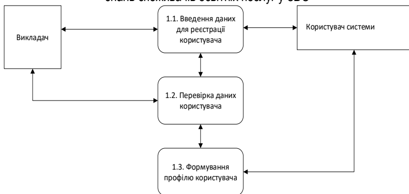
Рис. 8. Діаграма потоків даних Агента реєстрації користувача у системі оцінювання знань споживачів освітніх послуг у ЗВО
