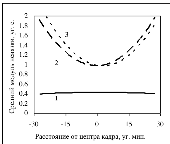
Рис. 3. Зависимость точности оценки экваториальных координат звезд от местоположения соответствующих им отметок на ПЗС-кадре
