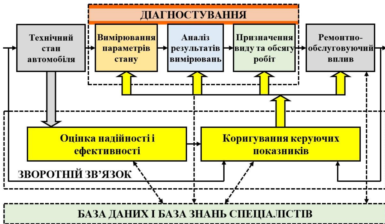
Рис. 3. Схема управління технічним станом вантажних автомобілів
