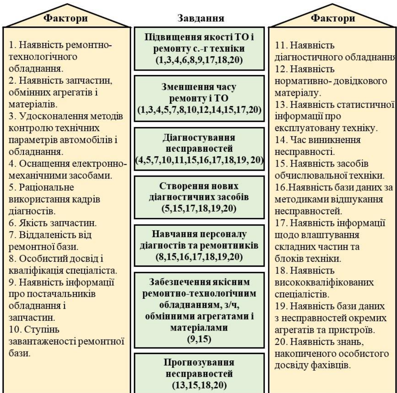
Рис. 2. Фактори, що враховуються експертами при вирішенні завдань удосконалення системи технічного обслуговування вантажних автомобілів
