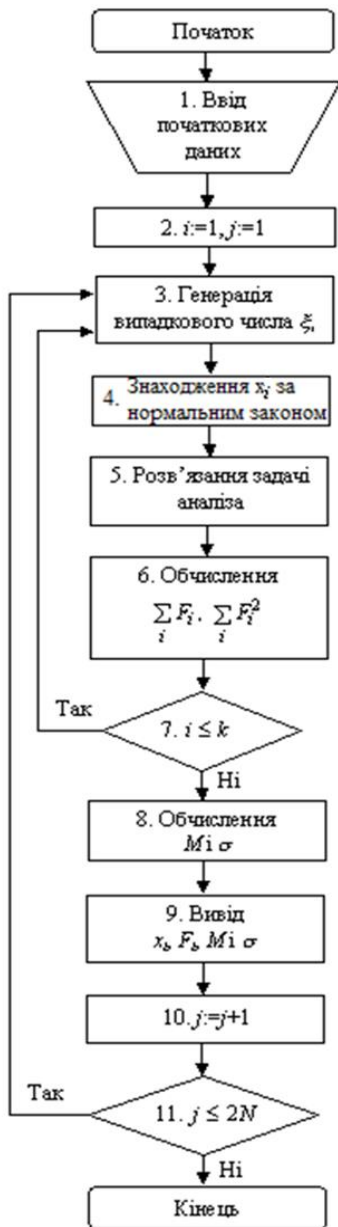
Рисунок 1. Блок-схема роботи методу Монте-Карло при дослідженні чутливості параметрів шарів оптичних структур до похибок
