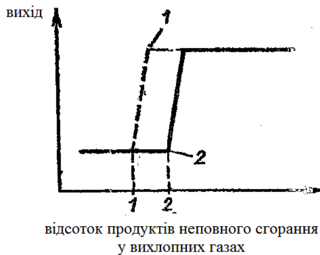
Рис.2.3. Гістерезис у вимірювальному перетворювачі:
