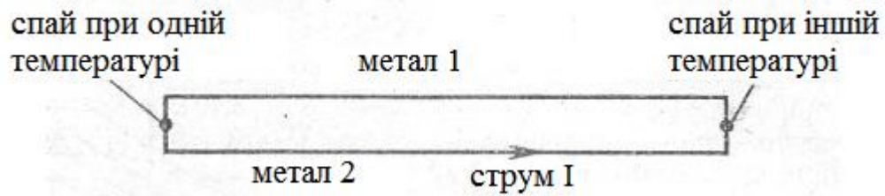
Рис. 4.16. Ефект Зеебека, при якому в схемі, що складається із спаїв двох різнорідних металів, що знаходяться при різній температурі, виникає струм
