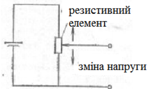
Рис. 4.1. Резистивне перетворення, при якому використовується пристрій потенціометра, що викликає зміну вихідної напруги
