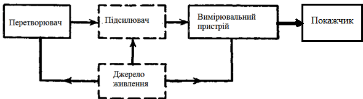
Рис. 2.1. Структурна схема електричного приладу для вимірювання неелектричних величин
