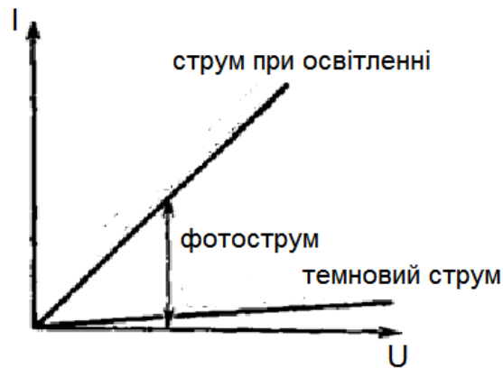
Рис.5.14. Вольт-амперна характеристика фоторезистора
