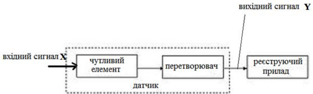
Рис. 2.4. Структурна схема первинного вимірювального перетворювача
