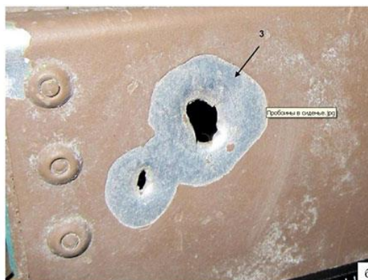
Рис. 3. Фото пробоїни фюзеляжу від уламків боєприпасу калібру 23 мм
