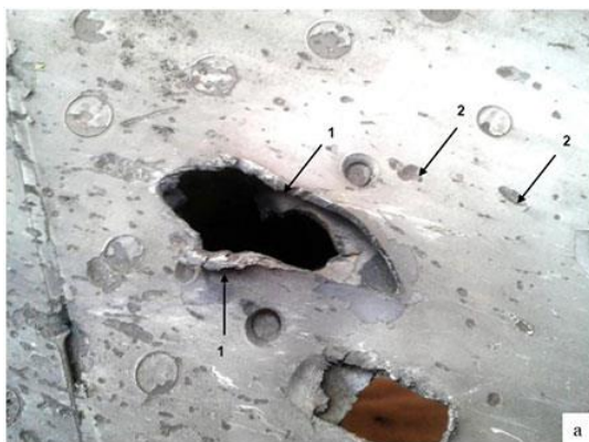
Рис. 2. Фото наскрізної пробоїни обшивки крила від боєприпасу калібру 30 мм
