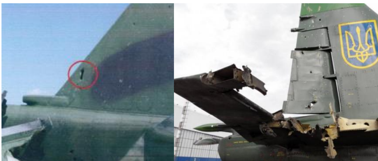
Рис. 11. Одиночне та багаторазове пошкодження кіля штурмовика Су-25.
