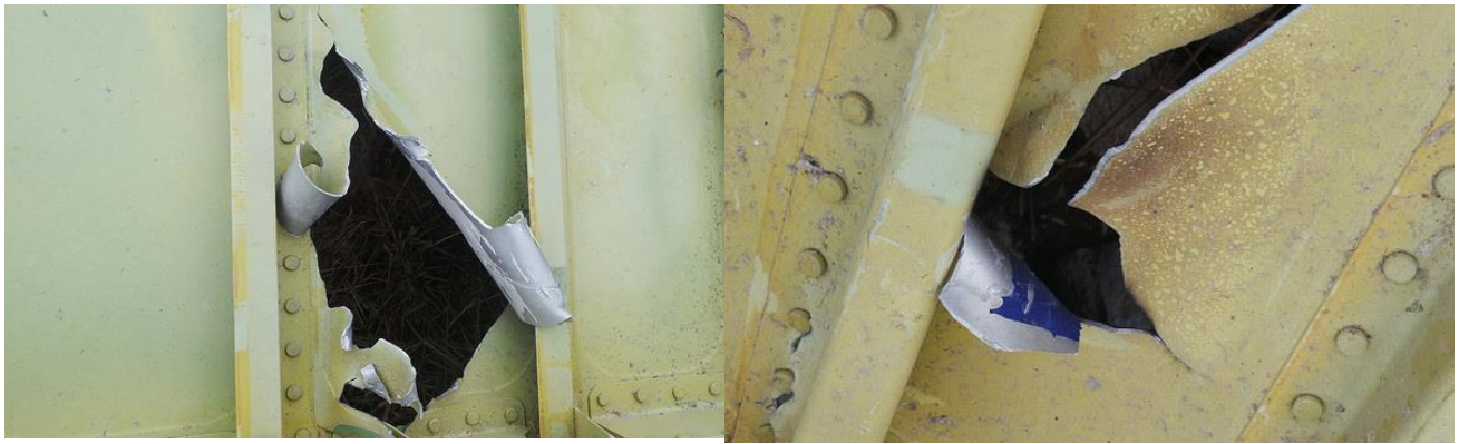
Рис. 4. Фото руйнування обшивки крила з руйнуванням стрингера
