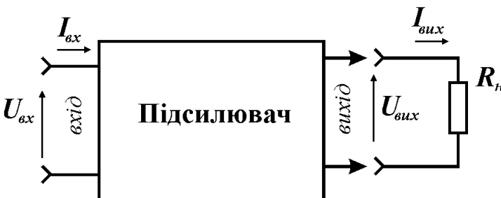
Рис.1. Підсилювач електричних сигналів як чотириполюсник.
