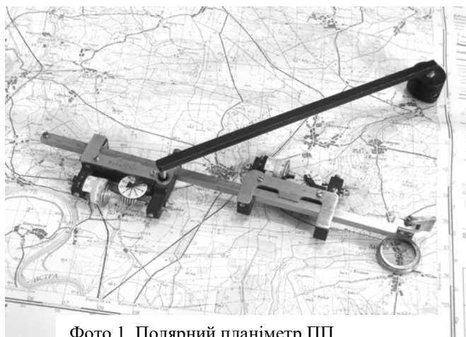
Фото 1. Полярний планіметр ПП
