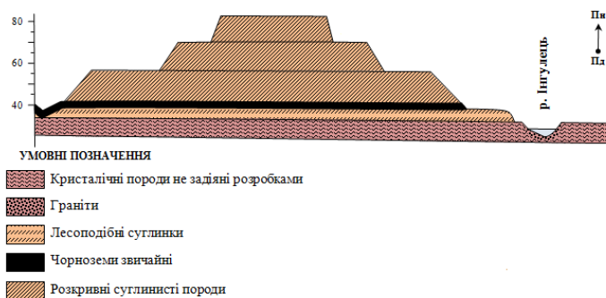
Рис. 6. Геологічна будова Бурщітського відвалу 27
