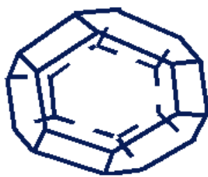
Fig. 2.2.10. Voronoi polyhedron of BCC (0,6, 0,8).
