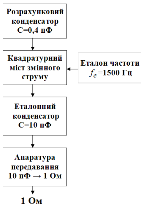
Рис. 14. Схема калібрування еталонного резистора 1 Ом за допомогою еталонного розрахункового конденсатора
