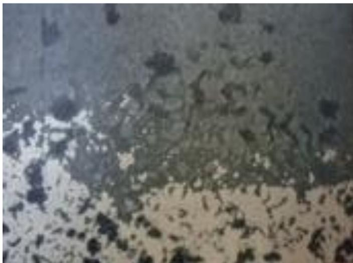
Рис.2. Шлиф спая металла с керамикой, содержащей 95% Al<sub>2</sub>O<sub>3</sub> (x200).
