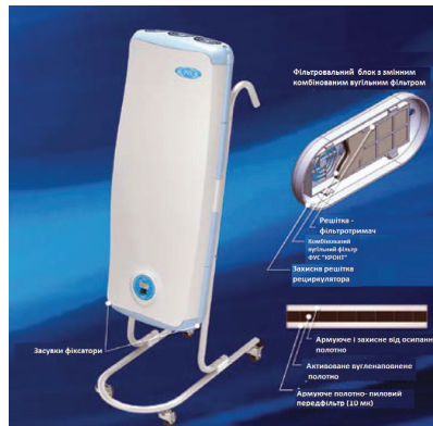
Рис.5. Приклад комбінованого пристрою (рециркулятора), що об'єднує УФ-рециркулятор з комбінованим фільтром.
