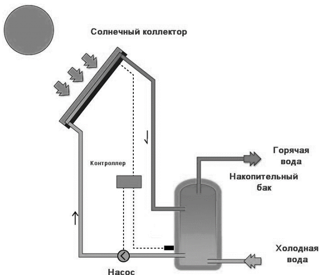
1-сурет. Қарапайым күн коллекторының схемалық көрінісі
