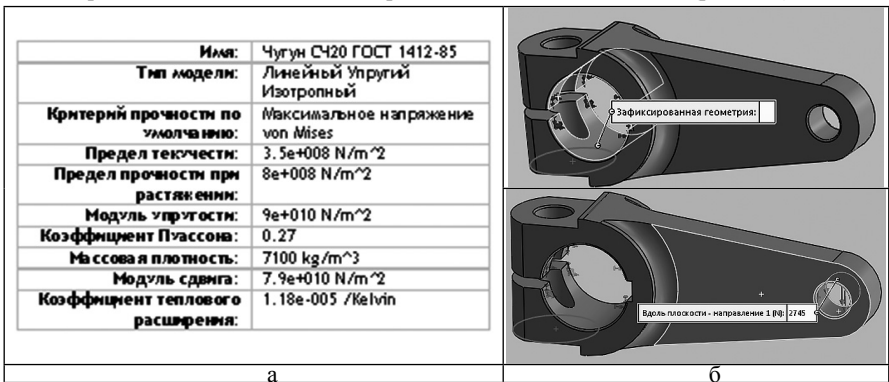
Рис. 1 – Параметры материала важеля (а) та його закріплення і діючі сили (б)
