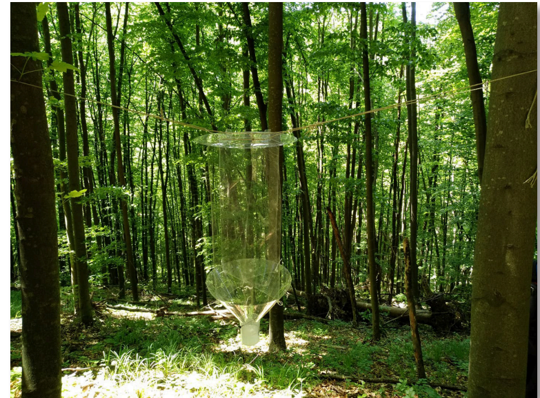
Рис.3.5. Зовнішній вигляд комбінованої прозорої пастки (політрап).
