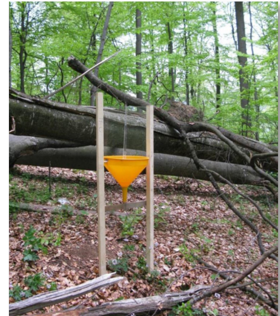
Рис.3.5. Зовнішній вигляд комбінованої прозорої пастки (політрап).
