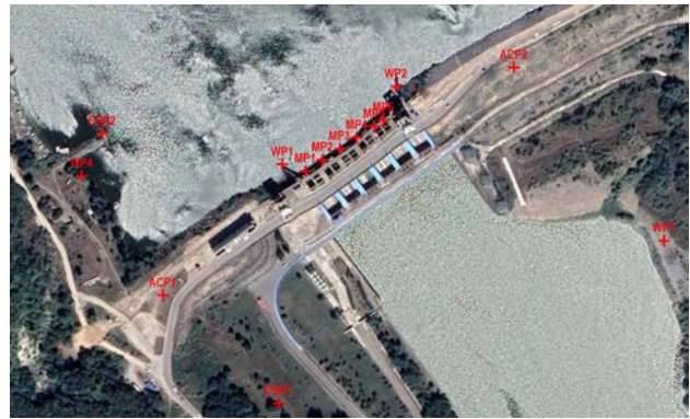
Рис. 1 Схема розташування пунктів системи моніторингу
