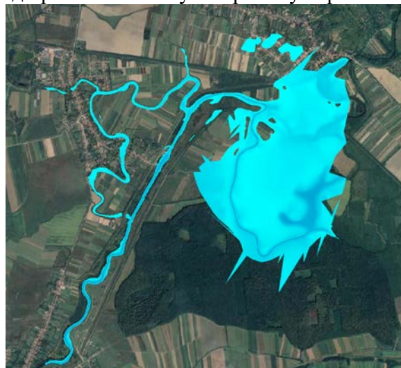
Рис. 4 Модель зон затоплення без гідротехнічних та інженерних споруд
