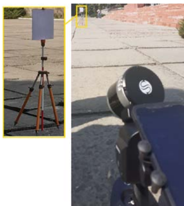
Рис.2. СМЛС Stonex X120 GO на пункті 23 НГП ІГД
