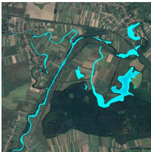
Рис.5. Модель зон затоплення з гідротехнічними спорудами
