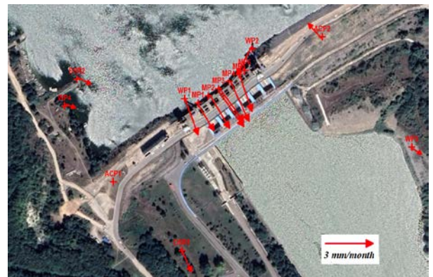
Рис.2 Схеми векторів горизонтальних швидкостей зміщень пунктів ССМПЗС Дністровської ГЕС-1 за період з 2021.6 по 2022.1
