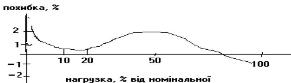
Рис. 6.2. Залежність похибки електричних лічильників від зміни навантаження.
