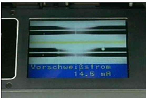
в) зварювання ОВ
