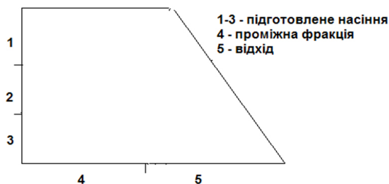
Рис. 2. Схема відбирання насіння на пневмостолі.
