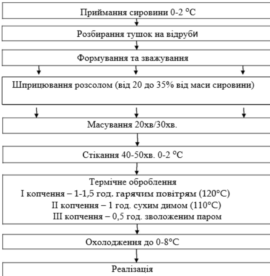
Рис. 1. Технологічна схема виробництва м'ясних делікатесів
