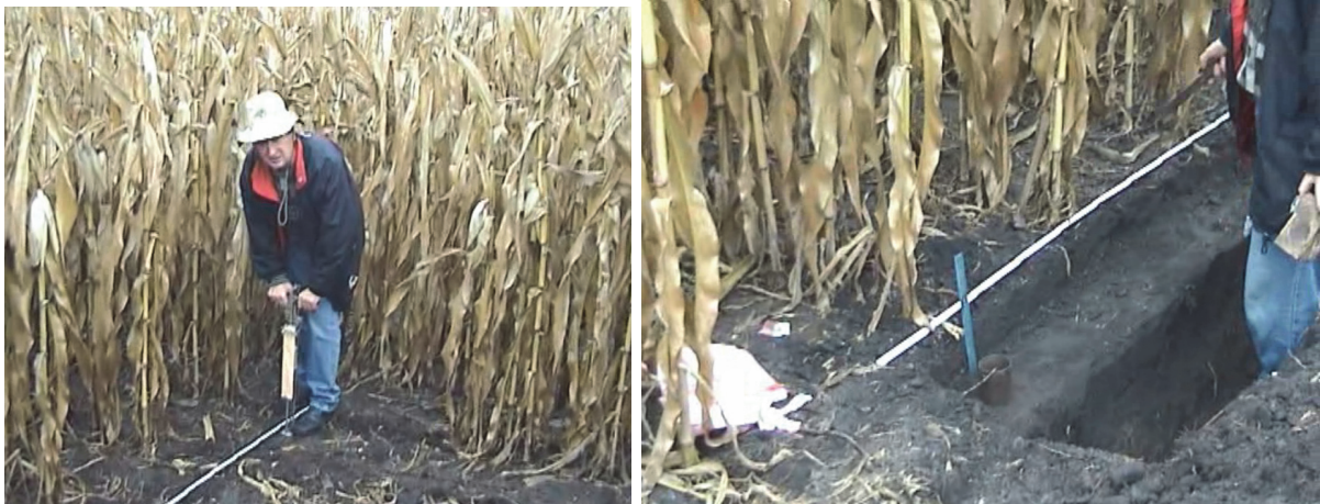
Рис. 1. Дослідження твердості і щільності складення чорнозему південного важкосуглинкового у посівах кукурудзи на зерно
