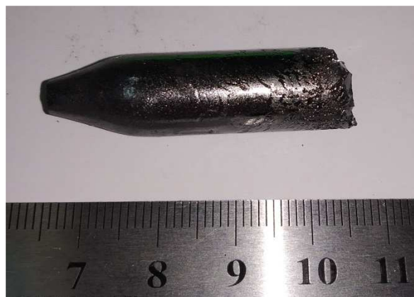
Рис. 4. Монокристал \text{Ag}_7\text{PS}_6 вирощений методом спрямованої кристалізації.
