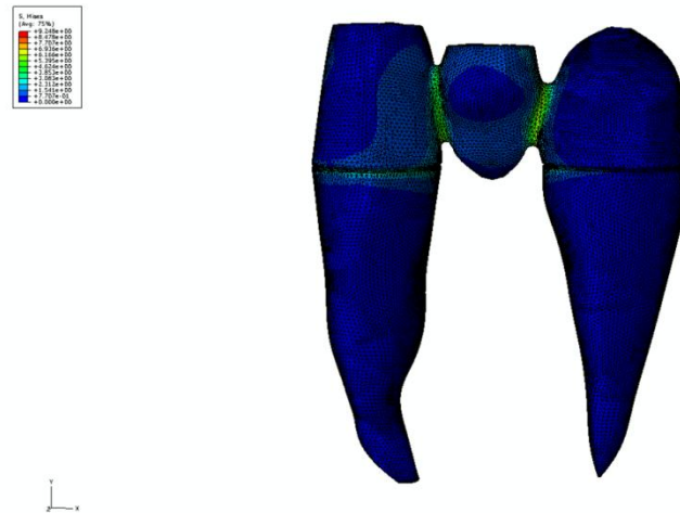
Рис. 6. Схема напружень, які виникають в каркасі мостоподібного протеза під дією жувального навантаження
