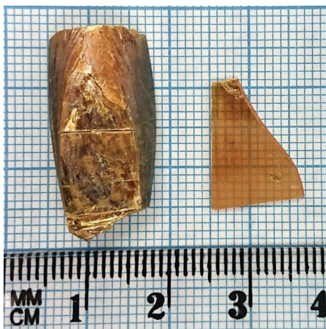
Рис. 2.9. Монокристали \text{CuInP}_2\text{S}_6 , отримані методом спрямованої кристалізації з розплаву.
