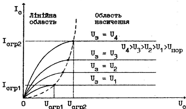
Мал. 8.4. Вихідні (стокові) характеристики ідеального МОН-транзистора
