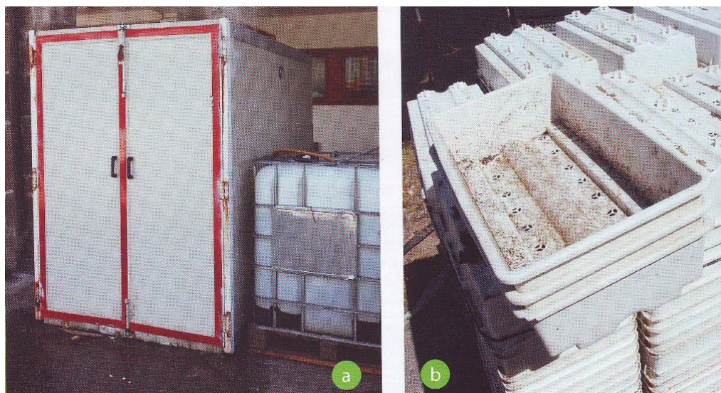
Рис. 38. Невелика парова камера для дезінфекції контейнерів для вирощування суниці (а) і контейнери підготовлені до дезінфекції (b)
