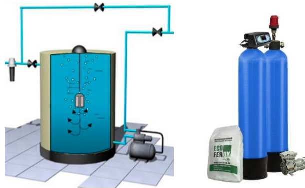
Рис. 13. Фільтр-аератор у розрізі і загальний вигляд
