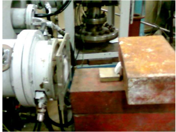
Рис. 3. Вигляд установки для опромінення активаційних детекторів у пучку гальмівного випромінювання.
