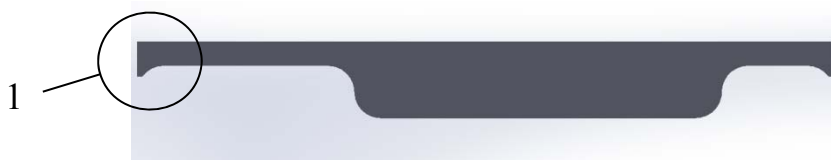
Рис. 5. Эскиз профиля пуансона для первого перехода штамповки:
