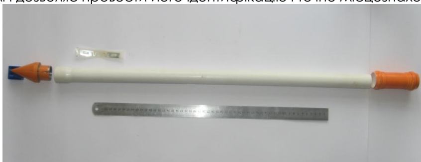
Конструкція межового знаку у розібраному виді
