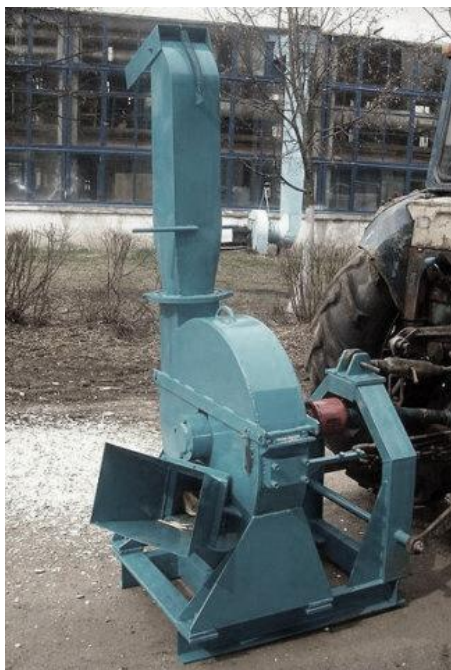
Рис. 1. Мобільна модифікація подрібнювача (привод від ВВП трактора)
