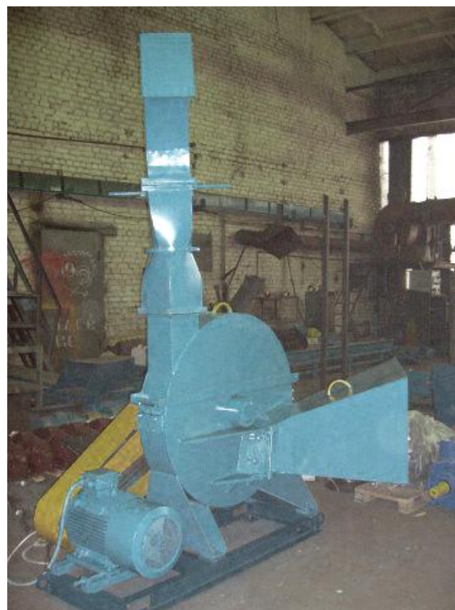
Рис. 2. Стационарна модифікація (привод від електричного двигуна)
