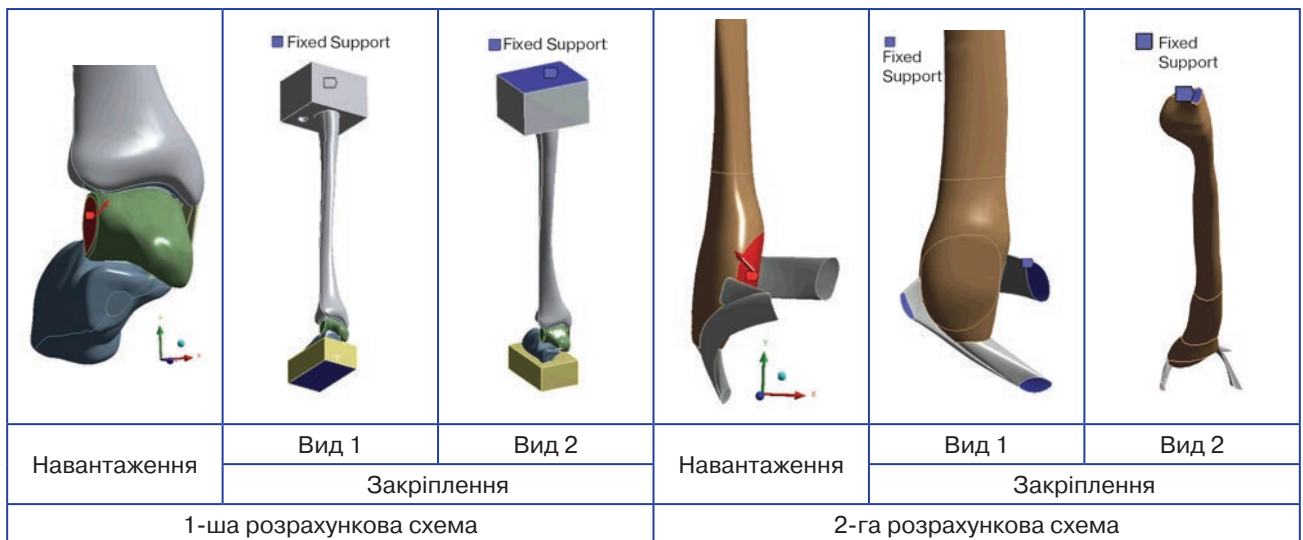
Рисунок 4. Прикладене навантаження та закріплення (спрощені досліджувані геометричні моделі)
